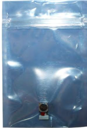
Coloque los conectores en la bolsa antiestática.
